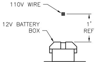
THE 110V WIRE SHOULD BE POSITIONED APPROXIMATELY 12" ABOVE THE 12V BATTERY BOX. ADJUST EXACT LOCATION FOR BEST FIT.
