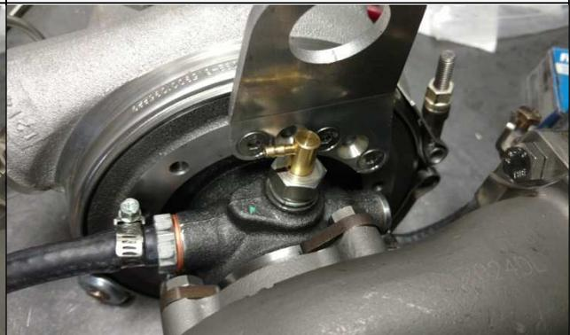
8) REINSTALL THE WASTEGATE BRACKET
