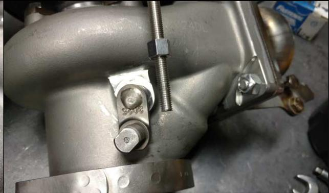
4) REMOVE THE OUTER/LOWER NUT ON THE WASTEGATE AND REMOVE THE ROD.
