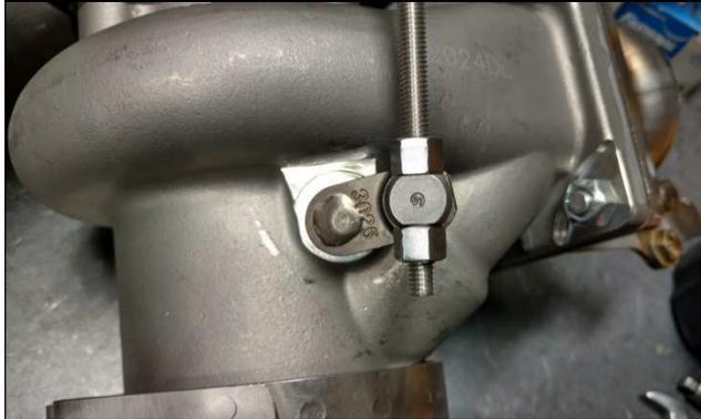
9) REINSTALL THE WASTEGATE ROD AND TAKE CARE NOT TO MOVE THE INNER/UPPER NUT SO YOUR BOOST LEVEL WILL REMAIN THE SAME.
